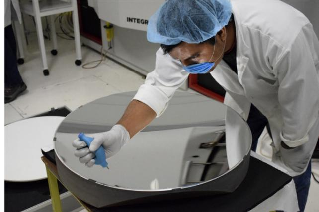
FIGURA 3.ESPEJO ZERODUR RECUBIERTO DEL PROYECTO WEAVE
