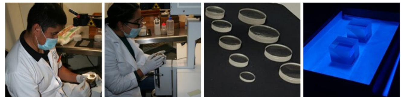
FIGURA 4. CEMENTADO DE COMPONENTES ÓPTICAS
