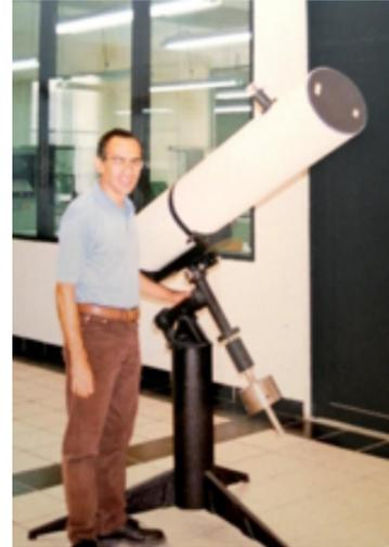
FIGURA 3. TELESCOPIO NEWTONIANO F/10 DE 200 MM DE ABERTURA ÓPTICA; EL DISEÑO ES ÓPTICAMENTE SIMILAR AL TELESCOPIO CASSEGRAIN DE LA FIGURA 2, PERO DIMENSIONALMENTE EL TELESCOPIO NEWTONIANO ES MUCHO MÁS LARGO
