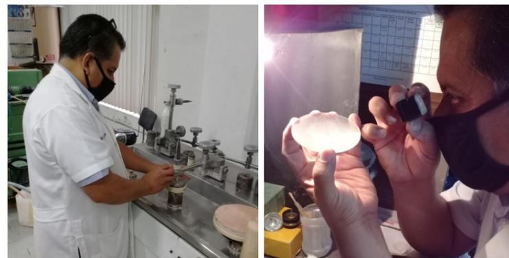
FIGURA 2. PULIDO DE COMPONENTES ÓPTICOS
