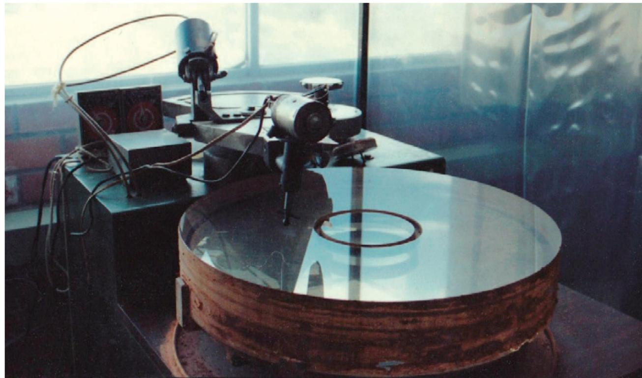
FIGURA 7. ESPEJO PRIMARIO DE 60 CENTÍMETROS EN POSICIÓN VERTICAL DURANTE UNA DE LAS PRUEBAS DE HARTMANN. SE APRECIA LA PANTALLA CIRCULAR DE HARTMANN, AÚN NO COLOCADA SOBRE EL ESPEJO
