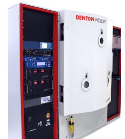
EVAPORADORA DENTON CON CAPACIDAD DE 90 CM EN DIAMETRO PARA SUPERFICIES ESPECULARES Y 35 CM PARA ANTIRREFLECTORAS
