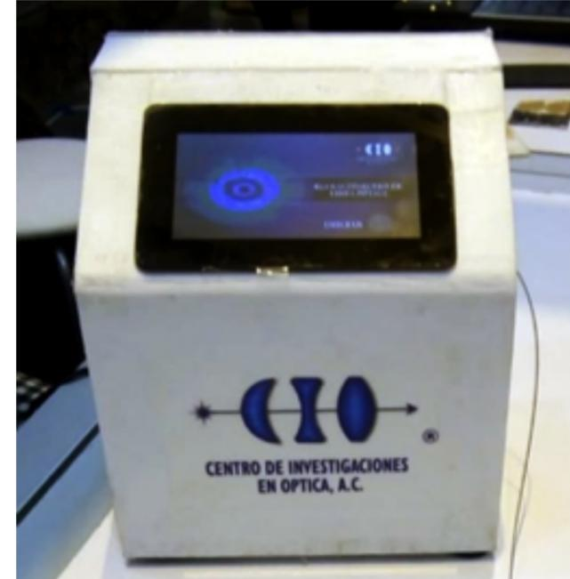
Figura 2.- Prototipo para medir índice de refracción.
