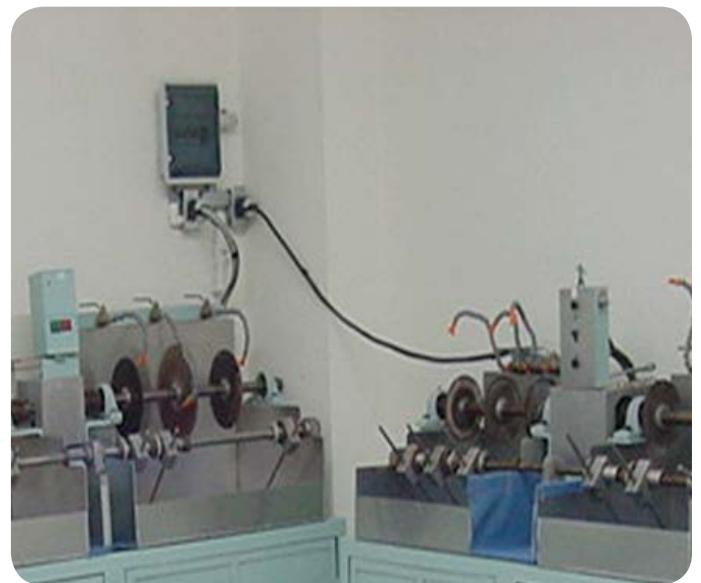
Cortadoras de discos múltiples. Maquinaria especializada para el corte de cristales de baja dureza, desarrollada en 1988 en las instalaciones de CALIPO S.A. de C.V. en Ensenada BC.
