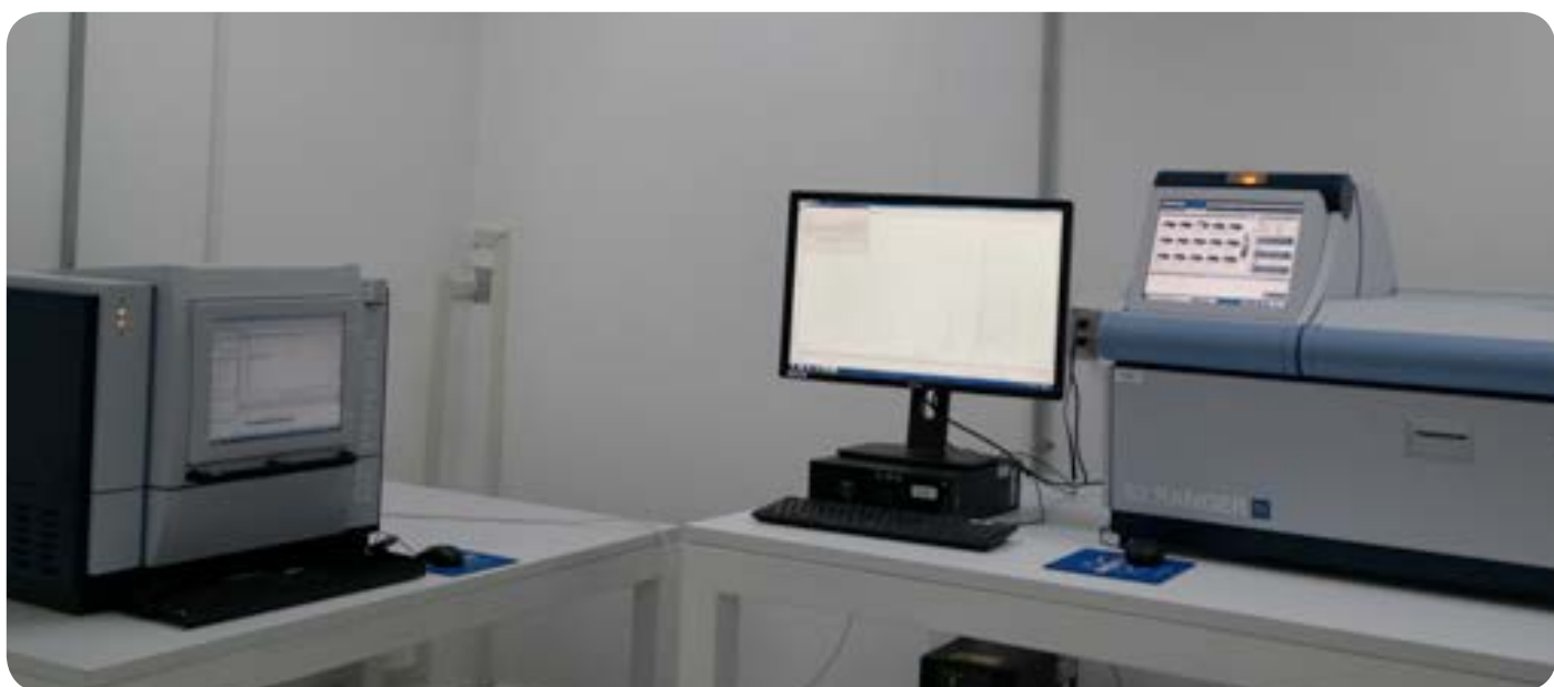
Equipos de difracción de Rayos X (Izquierda) y Fluorescencia de Rayos X (Derecha).
