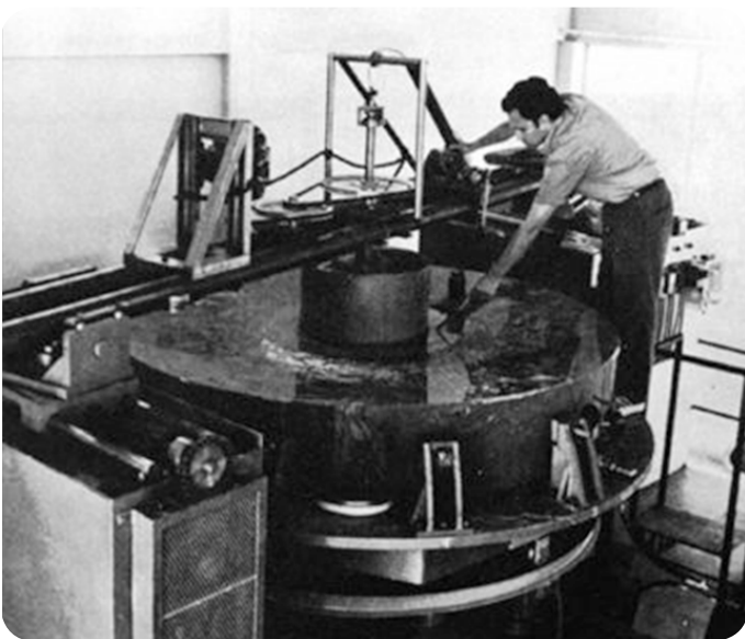
Perforación del centro del espejo primario de 210 cm de diámetro en el INAOE para el telescopio del actual Observatorio Astrofísico Guillermo Haro en Cananea, Sonora (circa 1974).
