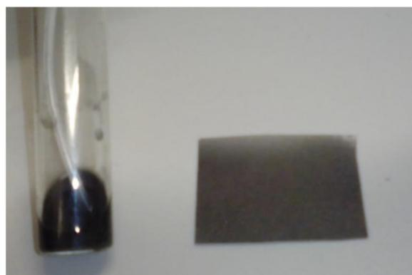
Fig. 4. Depósito de la tinta catalítica mediante spray
