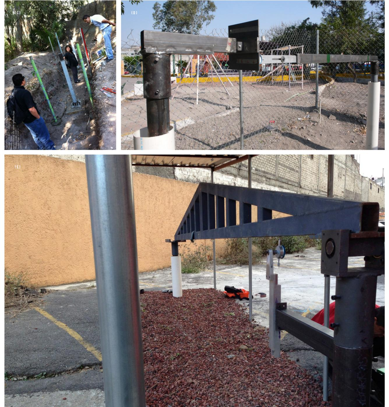
(A) DISEÑO DEL DISPOSITIVO 3D. (B) DISEÑO DEL DISPOSITIVO ANGULAR. (C) PREPARACIÓN PARA LA INSTALACIÓN DEL DISPOSITIVO ANGULAR, COL. LAS JACARANDAS, IZTAPALAPA. (D) DISPOSITIVO 3D INSTALADO, COL. SAN LORENZO, IZTAPALAPA. (E) DISPOSITIVO ANGULAR INSTALADO (ENTRE LOS DOS POSTES, SE OBSERVA UNA FRACTURA DEL TERRENO QUE CORRE TRANSVERSALMENTE).
