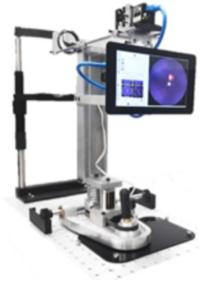
FIGURA 2. DISEÑO ACTUAL DE LA CÁMARA DE FONDO DE OJO DISEÑADA EN EL CIO.
