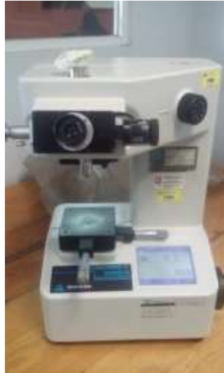
Figura 79. Microdurómetro MICROMET 2003 marca BUEHLER.
