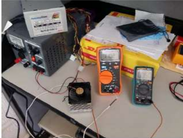
Figura 119. Prueba para la caracterización de la celda Peltier. Se utilizan dos multímetros con su respectivo termopar para medir la temperatura de cada cara y realizar el registro de las distintas temperaturas durante un tiempo. En este caso se tomaron muestras cada veinte segundos durante diez minutos.
