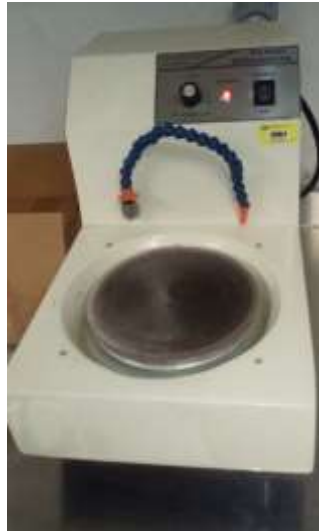
Figura 78. Pulidora metalográfica con disco giratorio y paño para materiales ferrosos.
