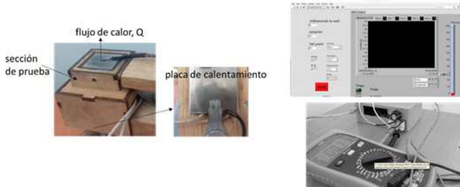
Figura 3. Banco de prueba diseñado para determinar la conductividad térmica de los materiales
