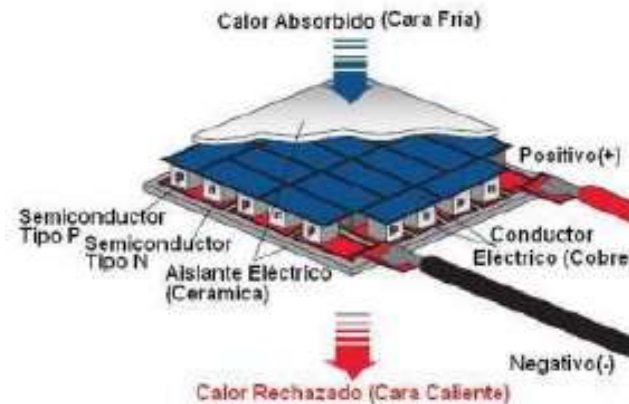
Figura 117. Diagrama de la estructura interna de una celda Peltier. Se observan los elementos semiconductores dispuestos eléctricamente en serie y térmicamente en paralelo. Recuperado de: (Rubio Cristian, 2017).
