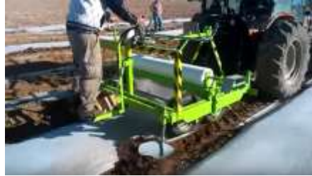
Figura 1. Acolchonadora de plástico y manta térmica.
