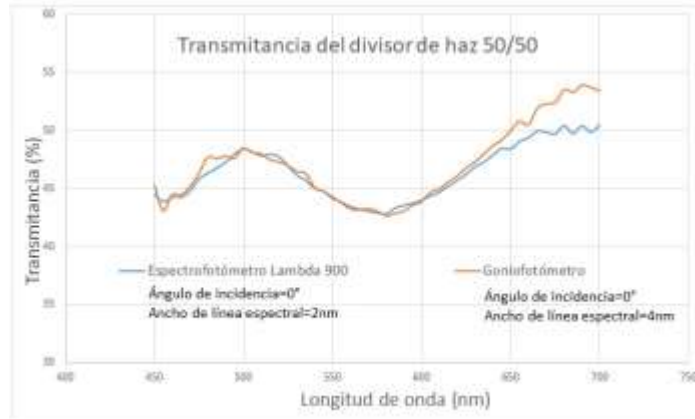
Figura 6: Curva espectral de la transmitancia de un divisor de haz 50/50 medida con el dispositivo y comparada con un instrumento comercial.
