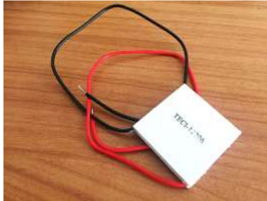
Figura 103 Celda Peltier modelo TEC1-12706 alimentación 12 V a 6 A
