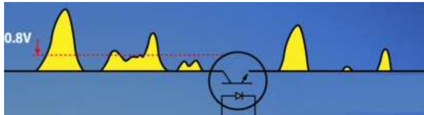
Figura 12.- El optoacoplador-BJT puede sensor señales de voltajes V_F > 0.8V .
