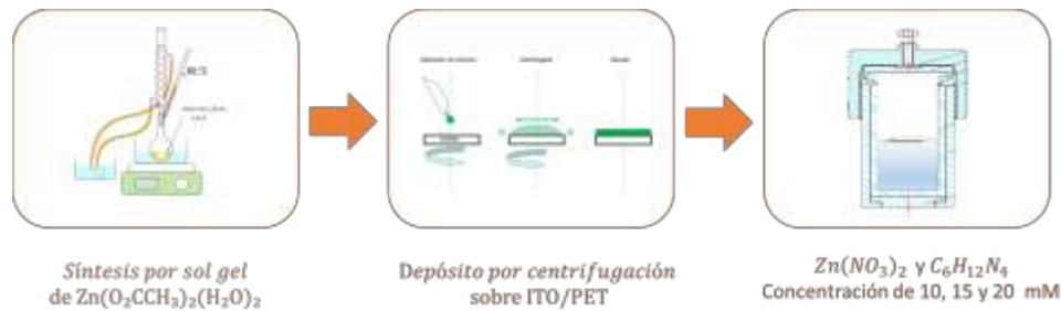
Figura 1. Esquema general del proceso de síntesis de ZnO por el método hidrotermal.
