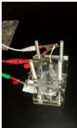
Figura 80. Celda electrolítica formada con una celda de acrílico una pequeña barra de grafito y un electrodo de Ag/AgCl.
