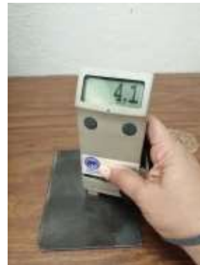
Figura 7. Medición de espesores
