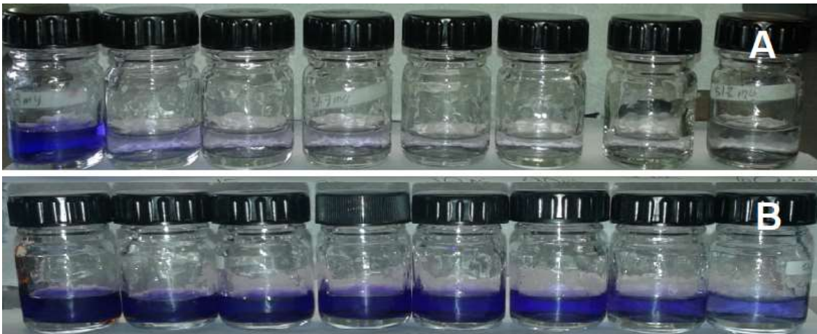
Figura 2. (A) primer proceso de remoción y (B) décimo proceso de remoción del colorante
