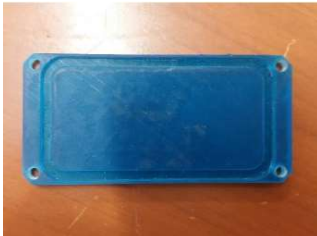
Figura 120. Tapa impresa en resina. Es una copia de la tapa que se encuentra en el microscopio electrónico de barrido. Debido a que esta tapa es necesaria para el funcionamiento del microscopio no podrá ser retirada por mucho tiempo. Por ello fue necesario modelarla en 3D para su posterior comparación con la original.
