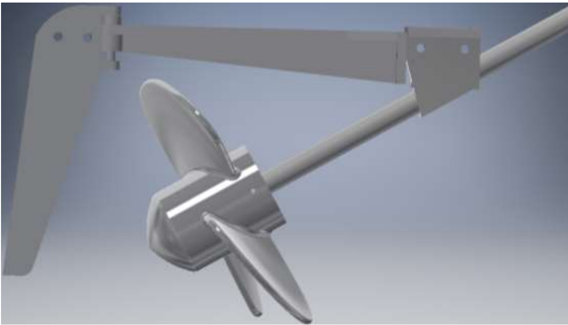
Figura 13. Ensamble de sistemas ( propulsión y mando)
