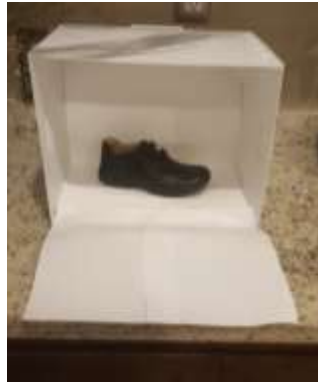
Fig. 5. Caja de luz diseñada para la adquisición de imágenes
