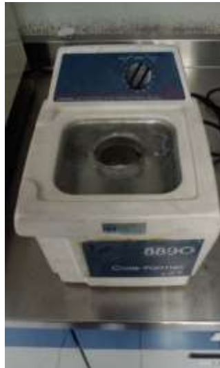
Figura 76. Aparato de limpieza por ultrasonido Cole-Palmer 8890.
