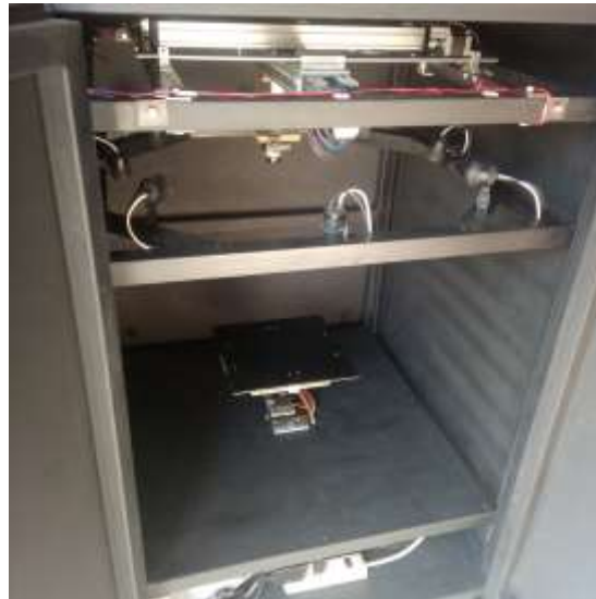
Figura 1.4 Equipo desarrollado para inspección óptica por termografía infrarroja LWIR.
