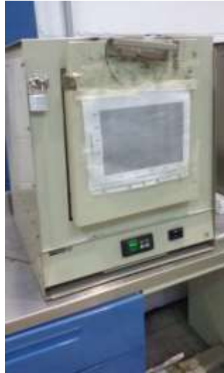
Figura 75. Mufla para tratamientos térmicos.
