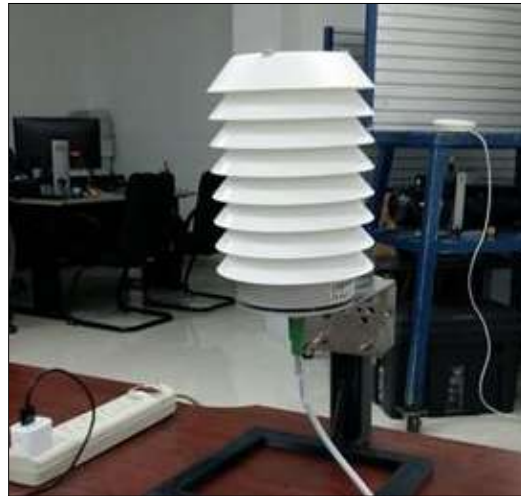
Figura 4. Sensor Vaisala AQT-420
