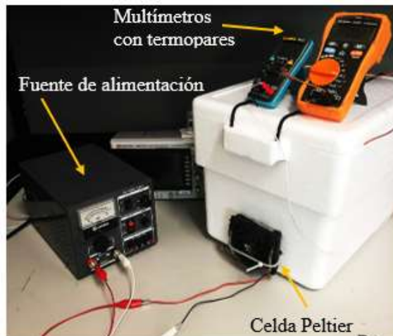
Figura 104. Sistema alimentado a 12V con monitoreo de temperatura.
