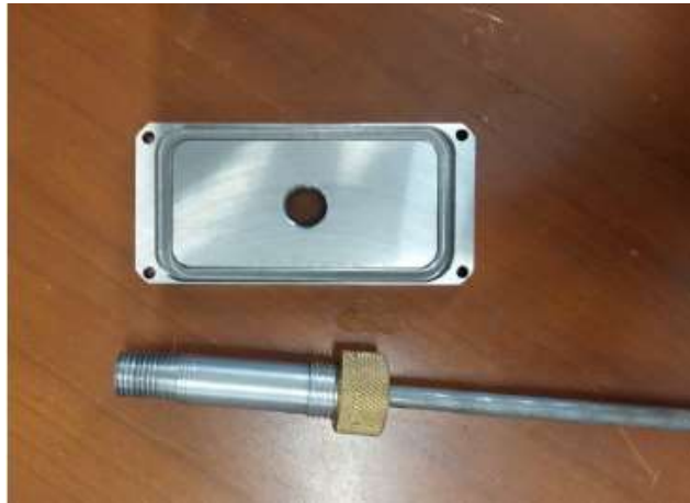
Figura 121. Tapa terminada. Después de verificar las medidas del modelo impreso en 3D, se procedió a llevarla al taller de maquinado para que fuera reproducida en una barra de acero inoxidable 304. También se añadió un pasamuros en el centro para la introducción de cables.
