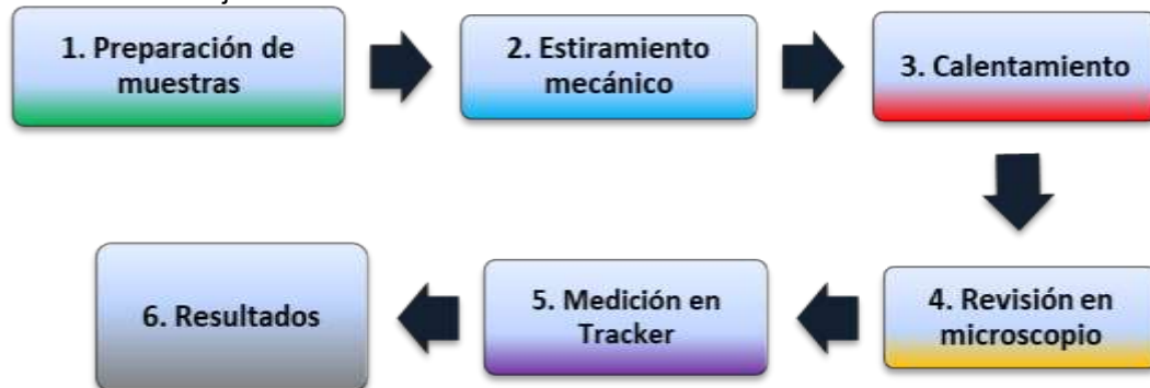
Figura 2. Proceso de desarrollo de fibra óptica adelgazada.
