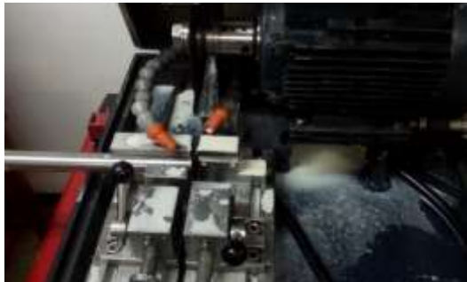
Figura 73. Corte a las barras de acero M2 y SISA Met M4 con cortadora de disco.
