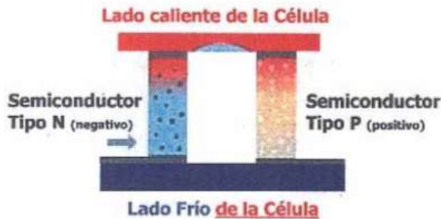
Figura 102. Funcionamiento de una Célula Peltier, la diferencia de temperaturas entre las caras es de 70°. Recuperado de (Blancarte Lizárraga, 2001)
