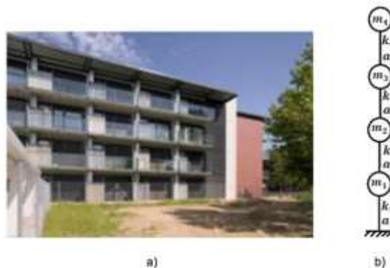
Figura 1: a) Situación real para un sistema de cuatro grados de libertad. b) Diagrama del edificio real de cuatro niveles.
