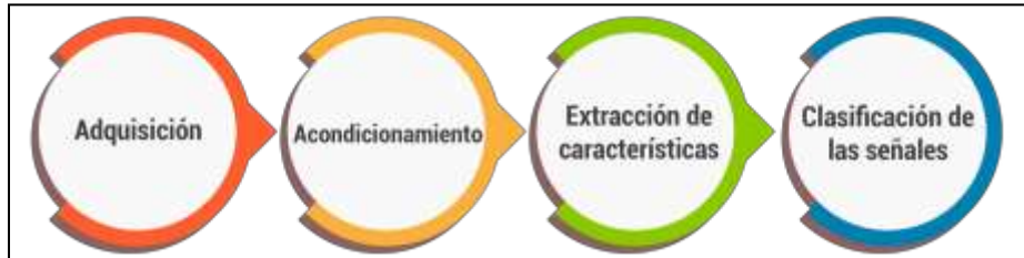
Figura 6. Diagrama a bloques del proceso de clasificación.
