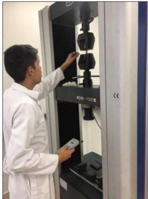
Figura 2. Realización de pruebas de Tensión en máquina universal
