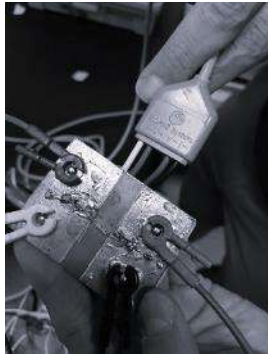
Figura 2. Tablilla de calibración para el sistema de bioimpedancia BIOPAC EBI100C®
