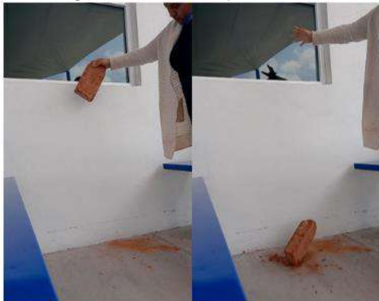
Figura 2. Verificación de la prueba de caída
