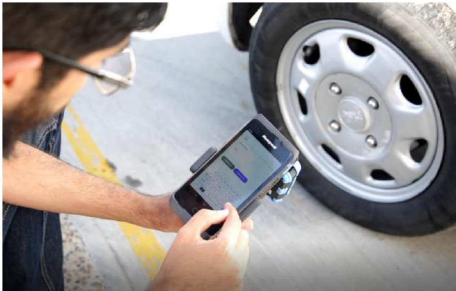
Figura 1: Identificación de la etiqueta mediante un lector RFID portátil
