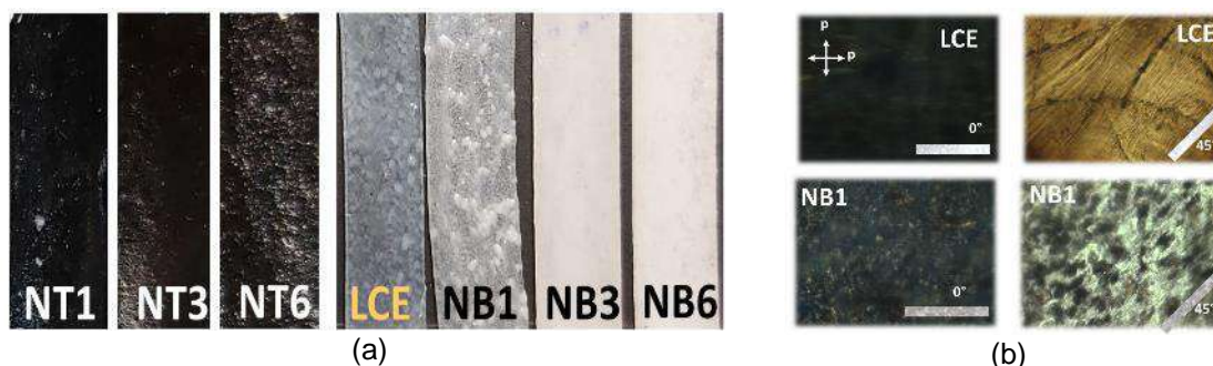
Figura 1. Fotografías de los elastómeros sin y con nanoestructuras (a) e imágenes POM de los LCE sin nanoestructuras y con 1% de NB, obtenidas a 0 y 45° (b).
