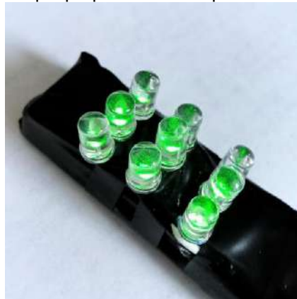
Figura 4. Matriz LED con longitud de onda central de 526 nm
