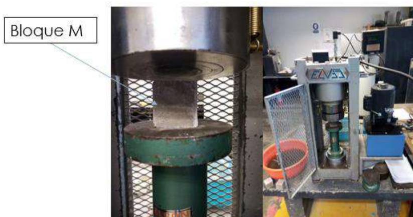
Figura 19. Pruebas destructivas con prensa hidráulica.
