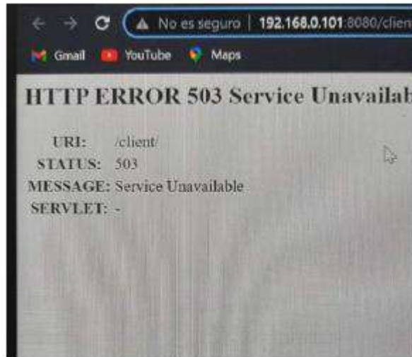
Figura 15. Error 503 provocado al usar un router-switch doméstico
