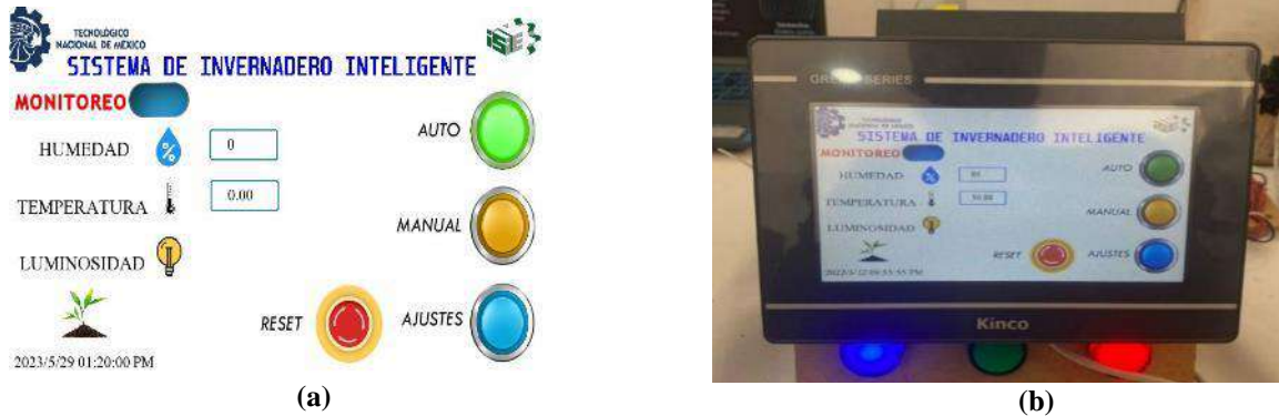
Imagen 4: (a) Diseño de interfaz Principal, (b) Interfaz de forma física en HMI
