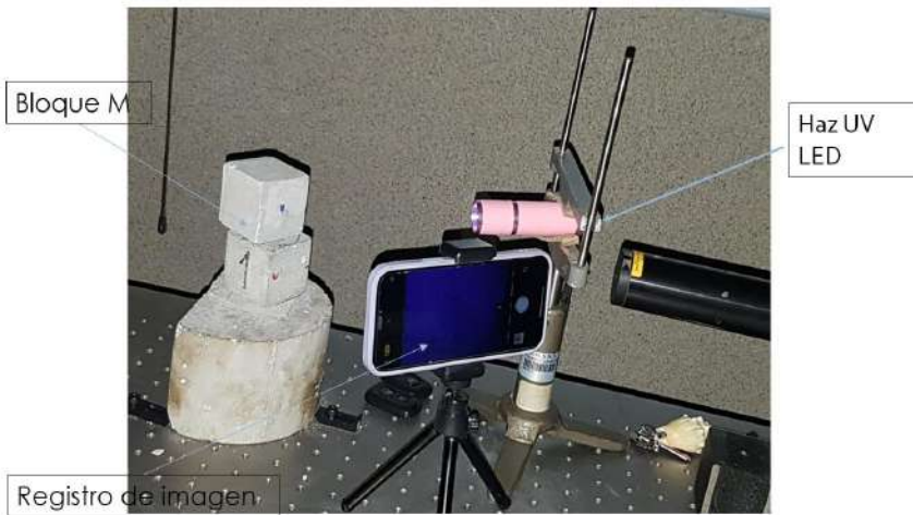
Figura 10.- Instrumentación con luz dispersa ultravioleta UV LED.
