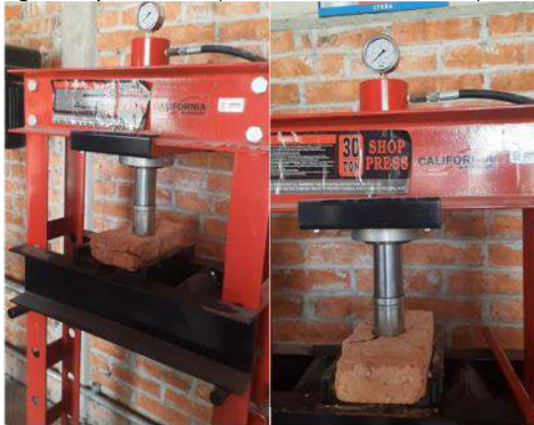
Figura 4. Ejecución de la prueba de resistencia a la compresión.
