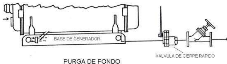
Figura 1.- Localización de válvula de purga.
