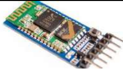
Figura 3. Bluetooth HC-05, utilizado en el proyecto
