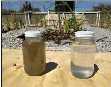
Figura 5. Comparación de muestras de agua a la entrada y a la salida del sistema de tratamiento.
