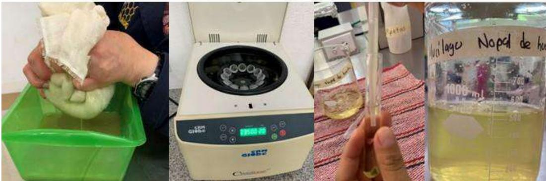
Figura 2. Izquierda a derecha. Filtrado de la sustancia con gasas. Centrifugado de la sustancia.
