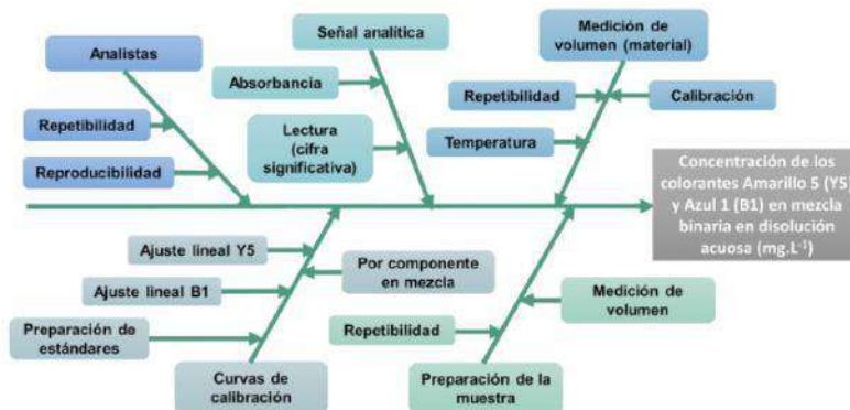
Figura 4. Diagrama de causa y efecto para la cuantificación de colorantes Amarillo 5 y Azul 1 en mezcla binaria en disolución acuosa (mg.L -1 )
