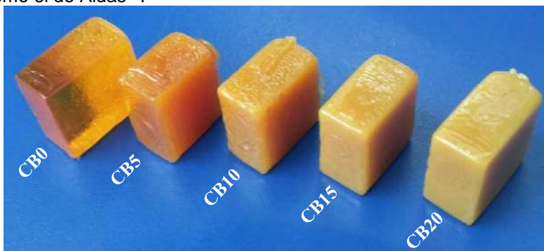
Figura 4. Compósitos colofonia-biosílice CB0-CB20.
