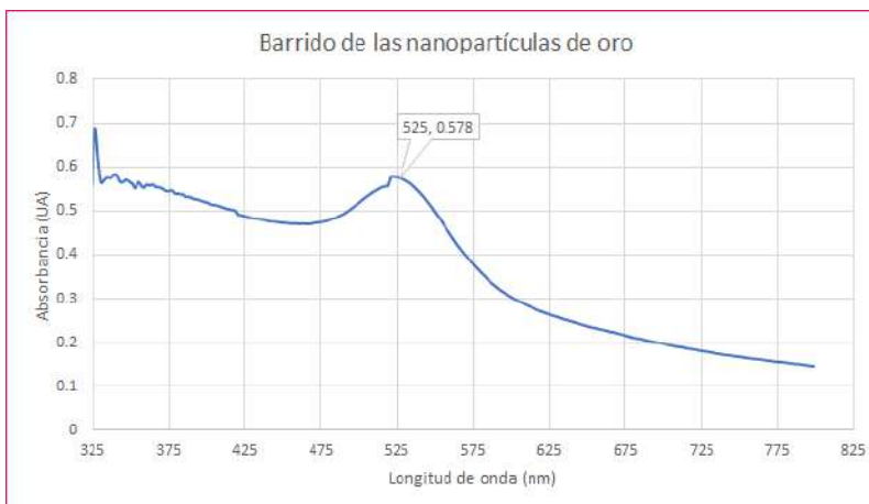
Figura 1. Gráfica del barrido obtenido de las nanopartículas de oro puras, con una λ máxima a 525 nm y absorbancia de 0.578 UA.
