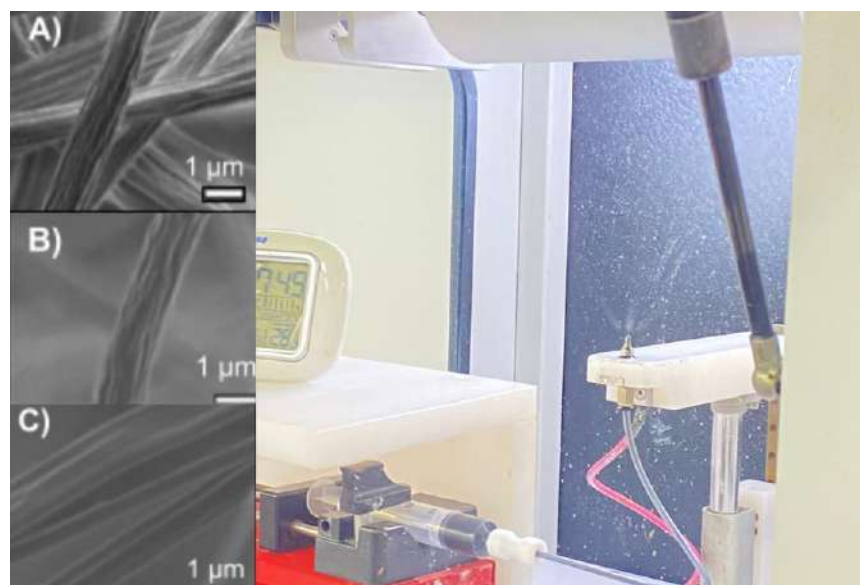
Figura 5. Caracterización morfológica por SEM de las fibras electrohiladas PCL-gel (control) (A) y las fibras con melanina 0.5% (B) y 2.0% (C). Equipo de electrohilado (D).
