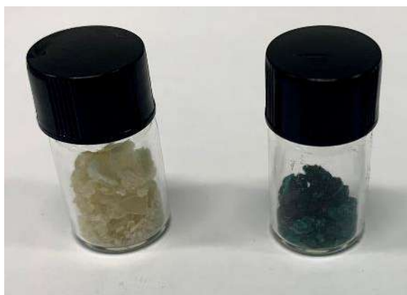
Figura 4. Polímero de impresión molecular con cobre (derecha)/polímero de impresión molecular sin cobre (izquierda).
