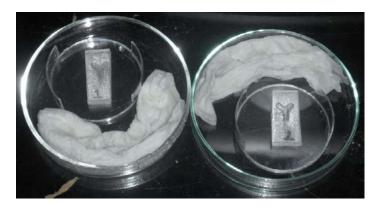
Figura 1.- Cámaras de microcanal incubadas en cámaras húmedas de cajas Petri
