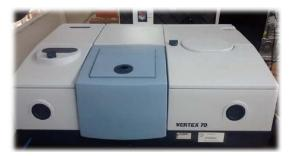
Figura 2. Espectrometro de Infrarrojo por Transformada de Fourier.
