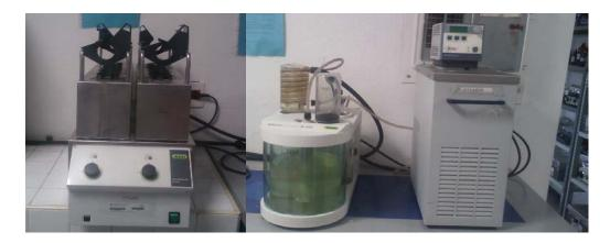
Figura 15. Unidad de Digestor Kjeldahl
