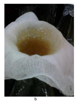
Figura 3: a) Extracción de pectina con etanol b) separación de la pectina
