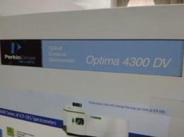
**Figura 6.** Espectrofotómetro ICP utilizado para la determinación de metales pesados en las pilas misma que se explica en dicha norma, específicamente para biosólidos, obteniendo los siguientes resultados en las 5 Pilas y en el lodo y estiércol respectivamente.
