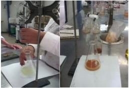
Figura 100. Precipitado rojo de cromato de plata
