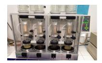
Figura 128. Sistema de Extracción de Grasa
