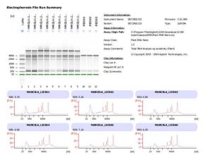
Figura 2. Resultados del análisis del RNA en el Bionalizer, Agilent Tecnologies Inc., indicando el RIN y las proporciones de RNA ribosomal
