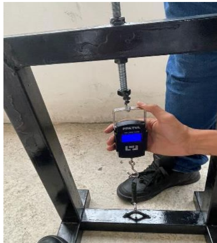
Fig. 1.3 Ejecución de un prueba de adaptación de la báscula digital.
