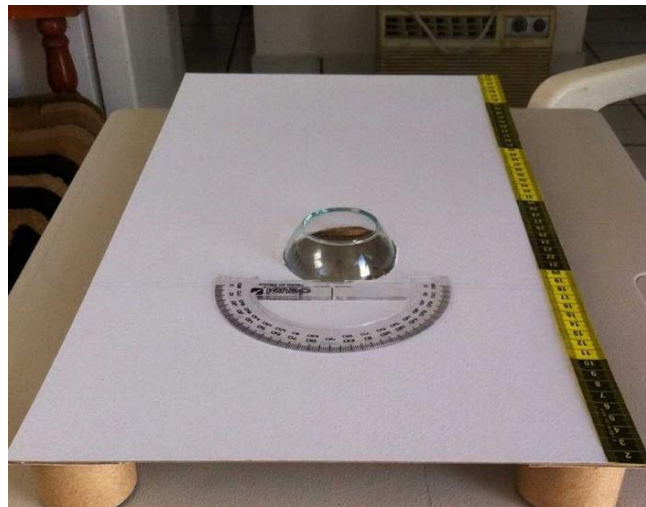
Figura 3. Primera propuesta de construcción de una lente esférica donde se le puede cambiar el índice de refracción a introducir diferentes fluidos.
