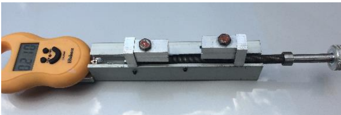
Figura 2. Mecanismo de tensión con celda de carga digital.
