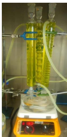
Figura 1. Dispositivo experimental para la disolución de hierro del caolín mediante extractos ácidos vegetales.
