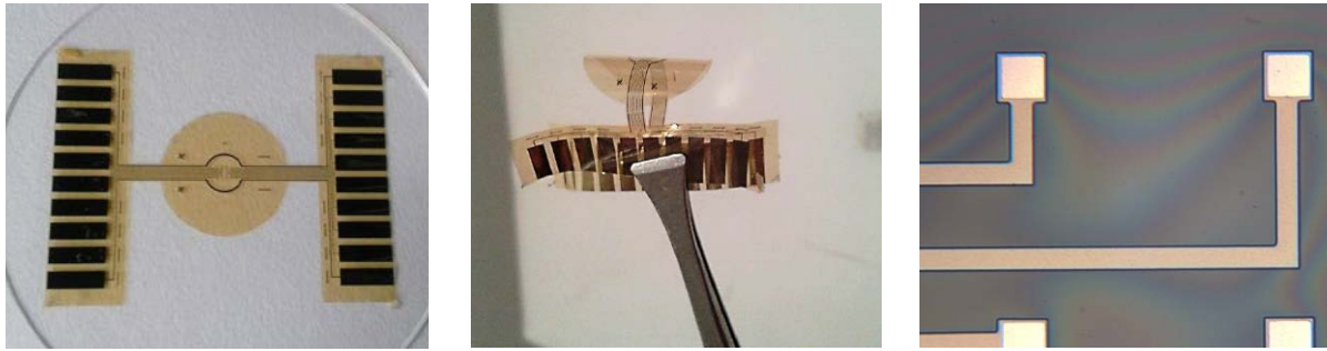
Figura 3. a) Chip de estimulación eléctrica, b) pistas metálicas después del proceso de liberación, c) parte del arreglo de microelectrodos.
