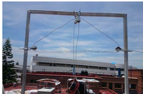
Figura 4.- Estructura para el seguimiento solar con altura de 2.6m, García Ramos (2017).
